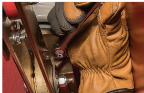
Figure 43 : Desserrer les boulons de fixation de la pièce coulée
