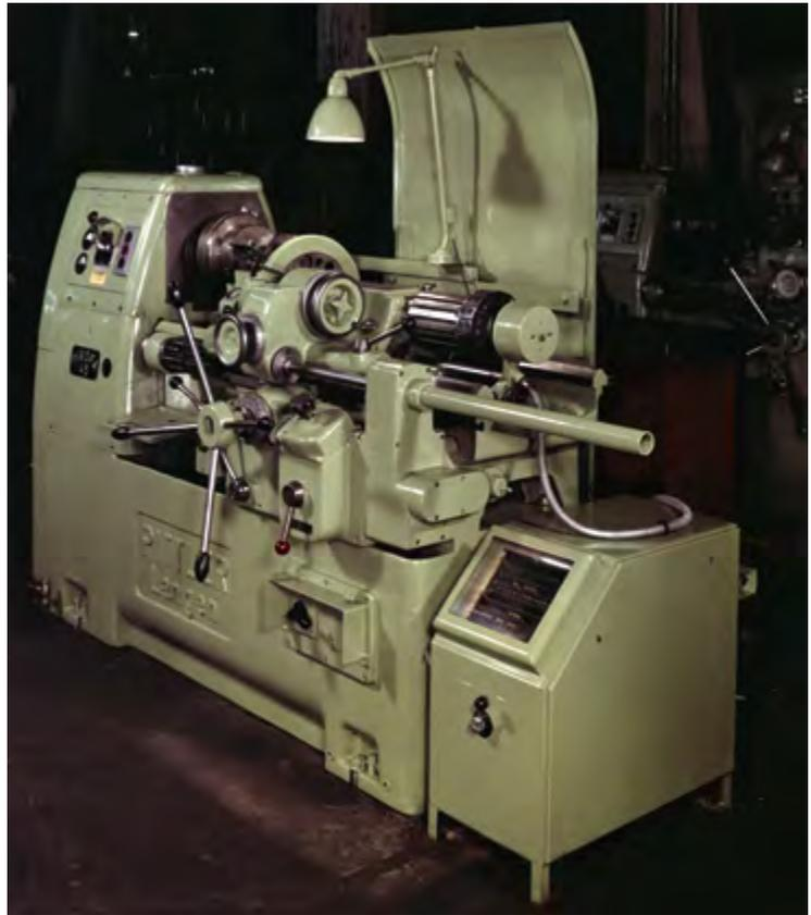
Revolverdrehbank mit SIMATIC-Bauteilen der Firma Pittler in Langen, 1959
