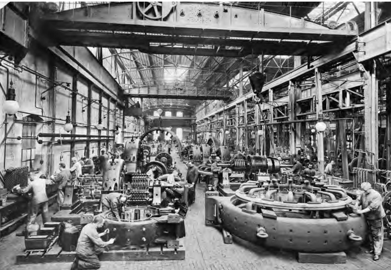
Montagehalle für Gleichstrommaschinen im
