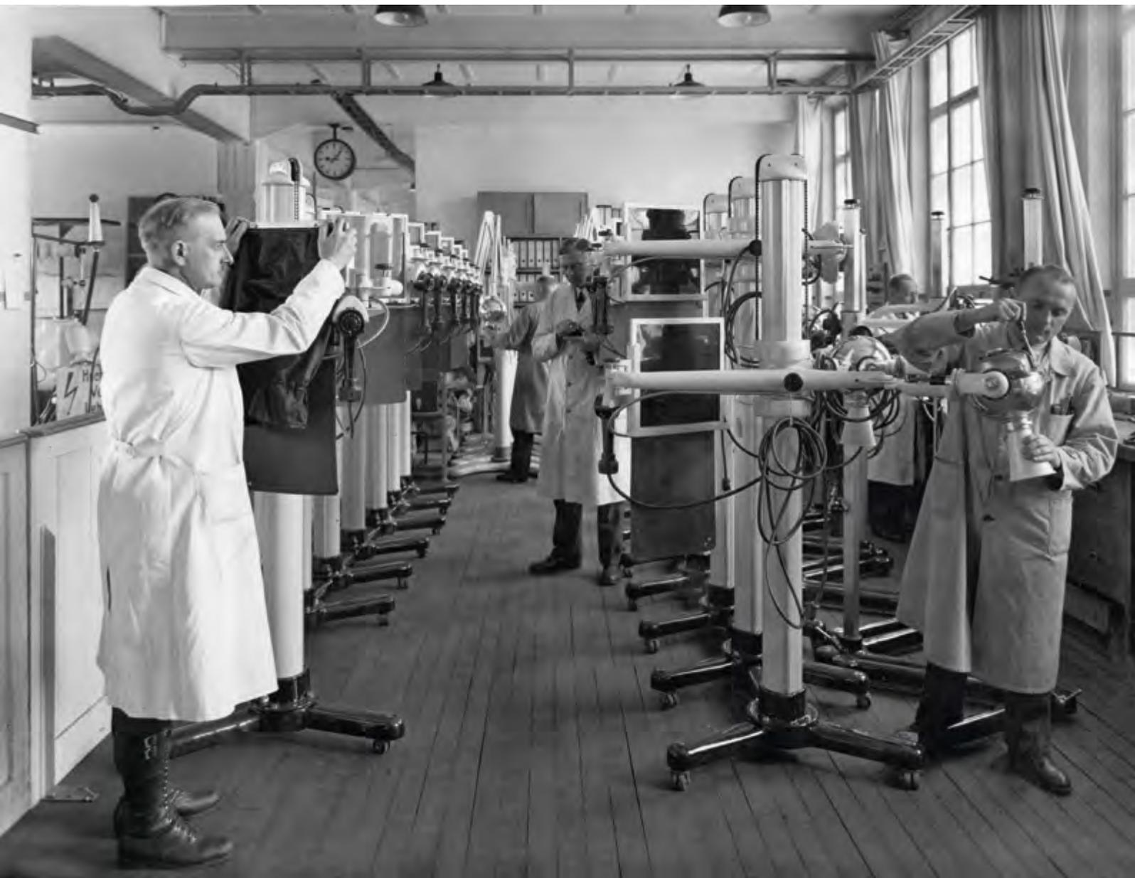
Fertigung von Röntgenkugeln bei der Siemens-Reiniger-Werke AG in Erlangen, 1940
