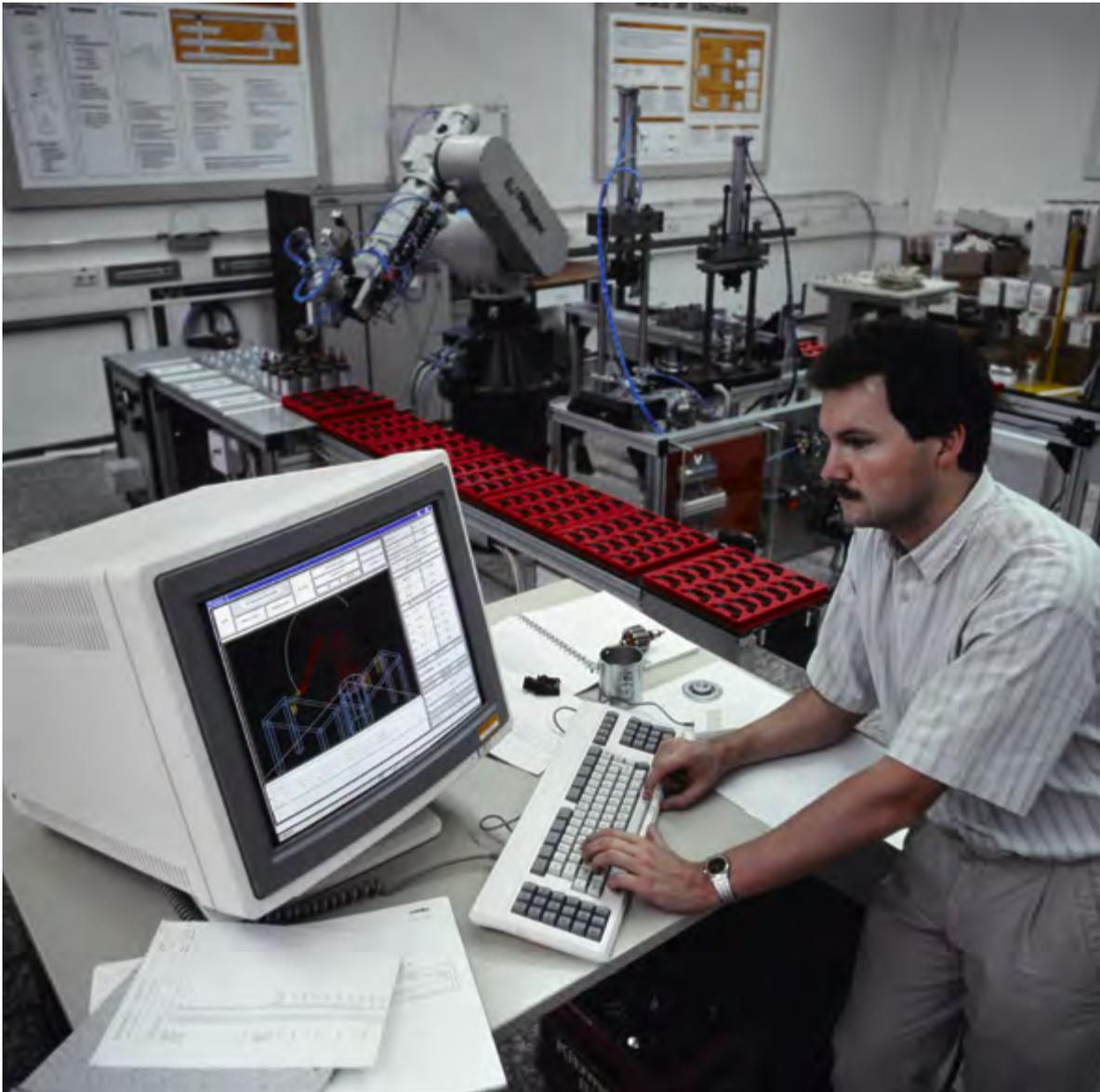
Experimentieren mit Simulationssoftware bei Siemens für den Einsatz eines Roboterarms, 1987
